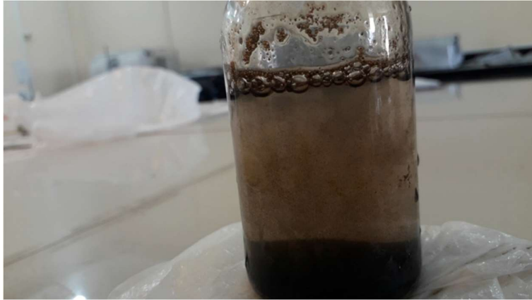
شکل ۹. استفاده از آهنربای خارجی به منظور جداسازی نانوذرات Fe_3O_4 سنتز شده از مخلوط واکنش
